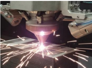
Схема и процесс лазерной наплавки методом прямого лазерного выращивания (ПЛВ).
